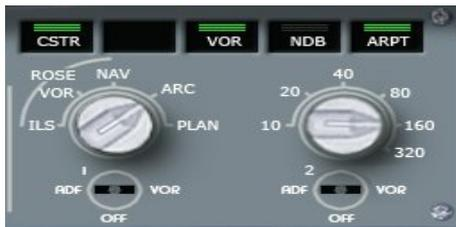
Les deux boutons du bas, 1 et 2 permettent d'afficher soit les VOR, soit les NDB dans le Navigation Display (pour changer, il faut cliquer sur ADF ou sur VOR).
