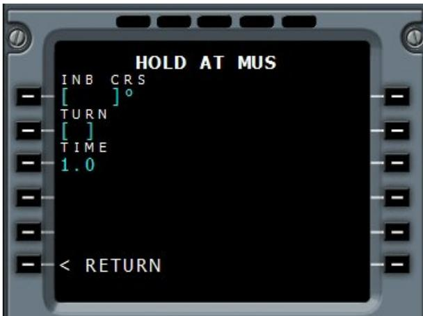
C'est là qu'il faut définir le circuit... On entre 148 dans INB CRS (inbound course), L (left) dans TURN et on laisse 1.0 pour 1 minute dans la branche.
