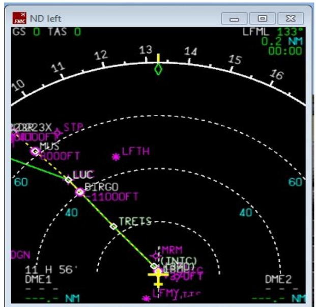
La TRANSITION se dessine sur le Navigation Display, On clique sur LSK6R INSERT.
