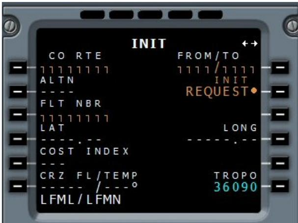
Il apparaît LFML/LFMN. Il faut alors tout de suite cliquer sur le bouton LSK3R à droite du texte écrit en orange ALIGN IRS... Cela sert à simuler les alignement des centrales d'inertie de votre appareil.
