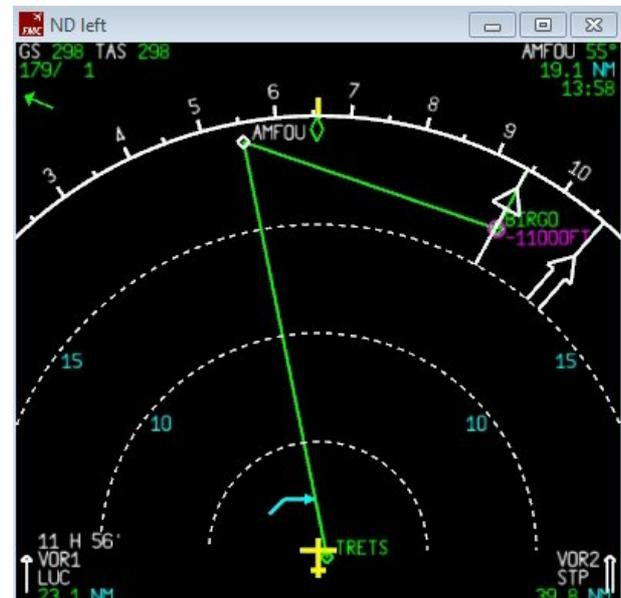
Notre avion vire sur la gauche et prend la direction du prochain point AMFOU.
