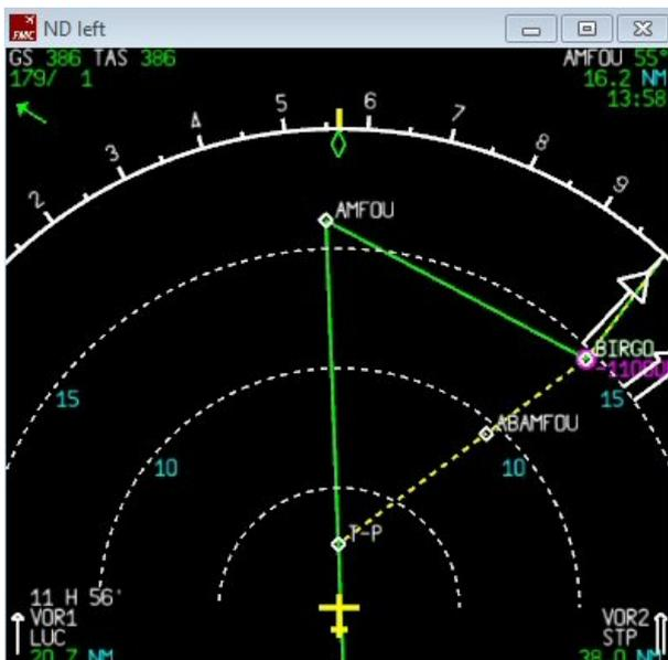
Une liaison en pointillés jaunes apparaît sur le plan de vol. Il suffit de confirmer le tracé en cliquant sur le bouton LSK6R en regard de INSERT.
