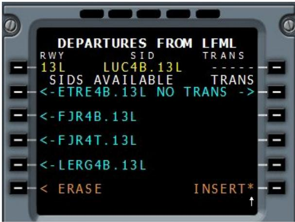
La SID LUC4B.13L est sélectionnée. Elle apparaît en pointillés jaune sur le tracé du Navigation Display.
