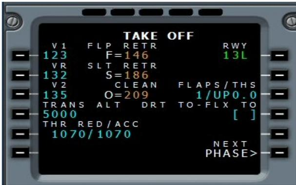
THR RED/ACC permet de définir les altitudes de réduction et d'accélération de la vitesse de l'avion. La réduction de vitesse est en général effective jusqu'à 1000 pieds au-dessus du terrain (ici 1000 + 70 pieds). Dans le cas présent l'avion restera à 135 kts jusqu'à une altitude de 1070 ft puis il accélérera à 250 kts pour monter (vitesse limitée à 250 kts ne-dessous de 10000 ft). En général on ne change pas ces données... Cliquez sur LSK6R à droite de PHASE pour passer à la phase suivante.
