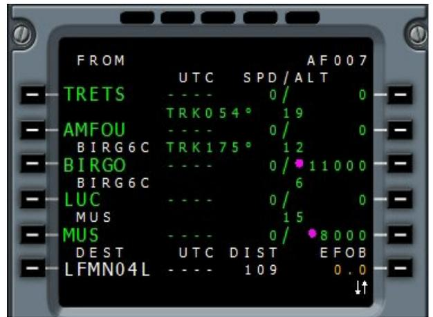
On saisit AMFOU au clavier puis on clique sur le bouton LSK2L en regard de BIRGO. Cela a pour effet d'introduire le point AMFOU avant BIRGO dans le listing et sur le trajet du Navigation Display.
