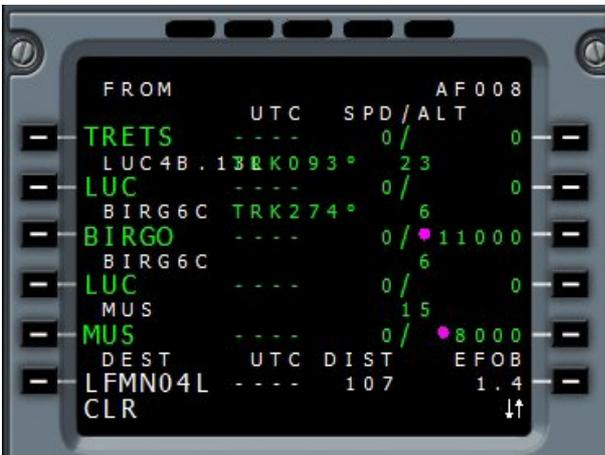
Il apparaît CLR en bas de l'écran du MCDU. On clique maintenant sur LSK2L le bouton à gauche de LUC (on clique bien sur LUC situé en dessous de TRET).
