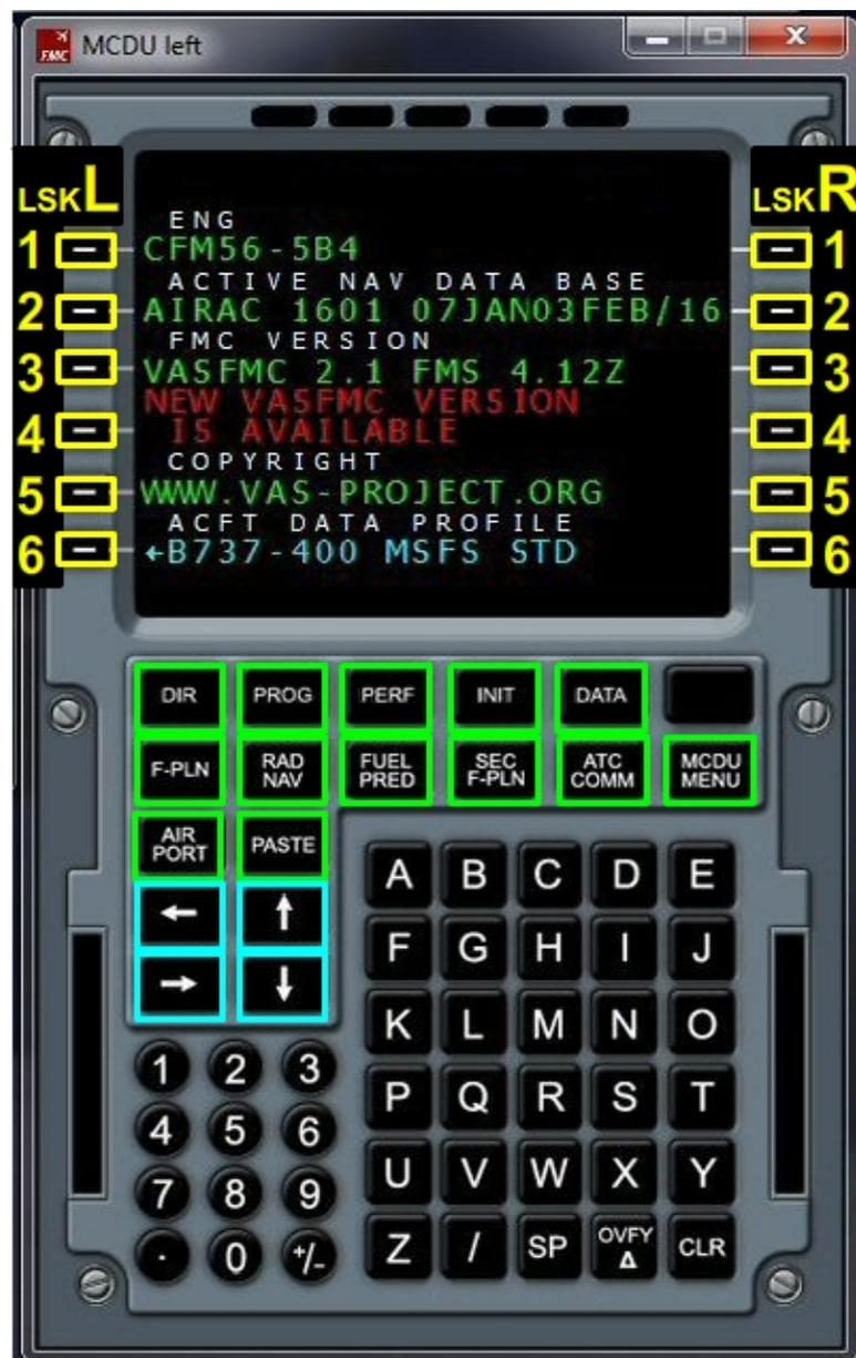
Le MCDU (Left ou Right) se compose d'un écran et de plusieurs jeux de boutons permettant de le programmer.
