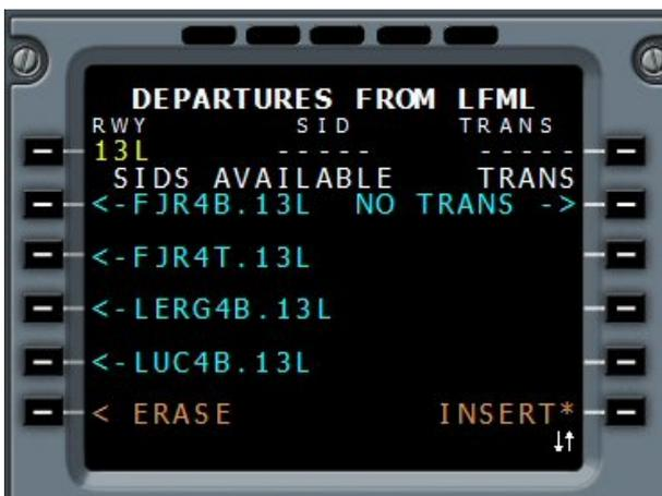
Voilà celle qu'il nous faut, la LUC4B.13L. On clique sur LSK5L le bouton à gauche de LUC4B...
