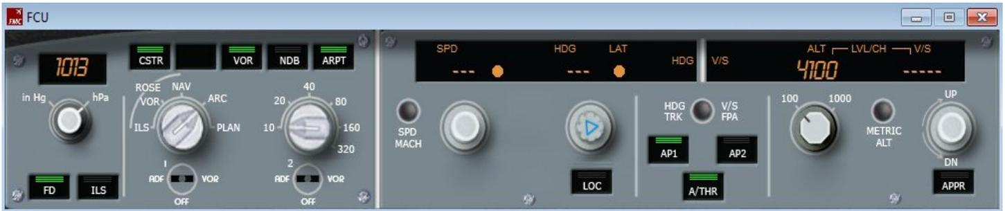
On vient de décoller, on enclenche l'auto throttle A/THR et le pilote automatique AP1.
