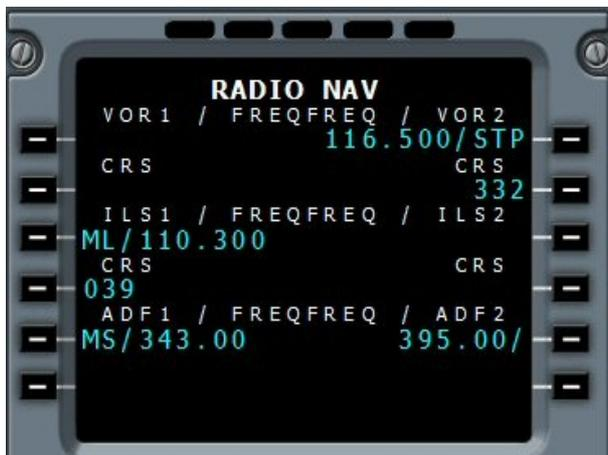
Si l'on met la fréquence 343 du NDB MS MARSEILLE et que l'on clique sur le côté gauche (ADF) du sélecteur 1, alors la direction du NDB sera indiquée par une flèche verte dans le Navigation Display.
