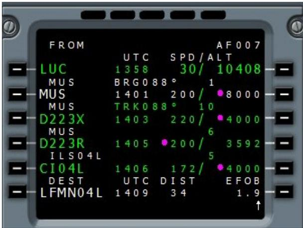
On prend le plan de vol du FMC et on clique sur le bouton LSK2L à gauche de MUS.
