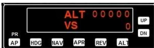
Ce dernier panneau permet de contrôler votre navigation sous **pilote automatique**.
