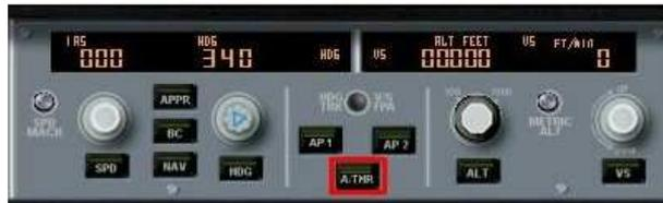
A THR (Auto Throttle ou Autothrust), bouton à bascule (ON/OFF, ON quand c'est vert) permettant d'enclencher la gestion automatique de la vitesse quelle que soit la phase dans laquelle on se trouve (montée, croisière ou descente). Attention, il faut absolument désenclencher l'auto-throttle à l'atterrissage !
