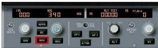
NAV, bouton à bascule (ON/OFF, ON quand c'est vert) permettant d'enclencher une navigation directe vers un VOR ou un VOR/DME dont la fréquence a été saisie préalablement. Une fois le VOR capté, le mode HDG (Heading) se désenclenche. Ne pas oublier de régler le "course" si on veut suivre une radiale de ce VOR. Quand le mode NAV est enclenché, l'inscription NAV apparaît à droite de l'écran de l'AFS. Ce mode ne fonctionne que sous pilote automatique.
