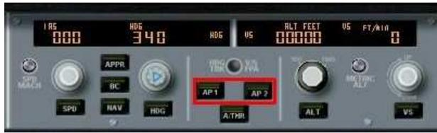
AP1 (Pilote Automatique), bouton à bascule (ON/OFF, ON quand c'est vert) permettant d'enclencher le pilote automatique. AP2 (Pilote Automatique), bouton à bascule (ON/OFF, ON quand c'est vert) permet d'enclencher le second mode du pilote automatique... AP2 n'est à enclencher que pour les atterrissages automatiques ILS. Attention, il est impératif d'enclencher le FD (Directeur de vol) avant d'engager le Pilote Automatique (PA).
