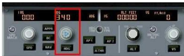
HDG (heading), bouton à bascule (ON/OFF, ON quand c'est vert) permettant d'enclencher une navigation sur un cap qui est à régler à l'aide du bouton rotatif. Ce mode ne fonctionne que sous pilote automatique. Quand le mode HDG est enclenché, l'inscription HDG apparaît à droite de l'écran de l'AFS. Ce bouton peut être poussé pour que la navigation latérale se fasse automatiquement. Il apparaît alors --- dans la fenêtre du HDG.
