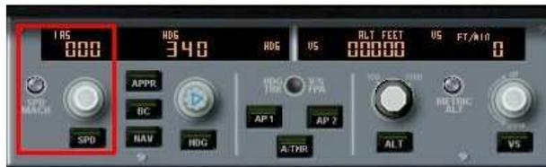
Le bouton rotatif sert à choisir la vitesse (speed, SPD) de l'appareil. En-dessous du niveau 100, FL100, celle-ci ne peut pas dépasser 250 kt. Sur le côté, Le bouton SPD-MACH permet au pilote de choisir l'affichage de la vitesse air en kt Knots (noeuds) ou Mach.
