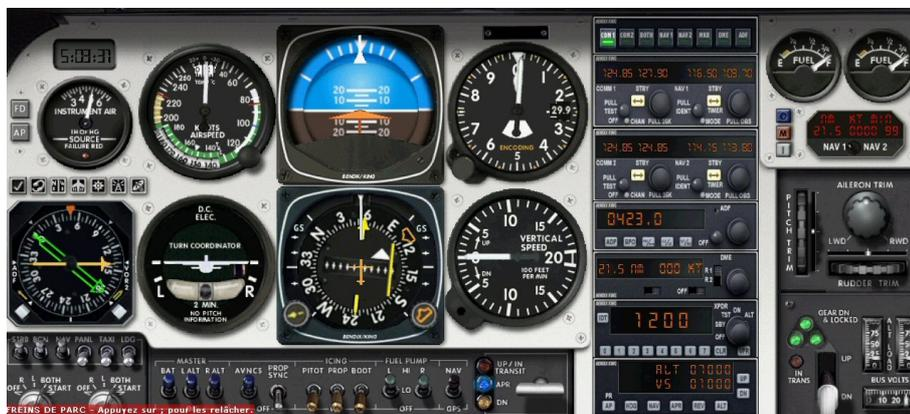
On vérifie que la pression barométrique est de 2991 mm Hg, pression QNH indiquée par l'ATIS. On règle l'altitude cible à 7000 ft et on prévoit un taux de montée de 1000 ft minute.
