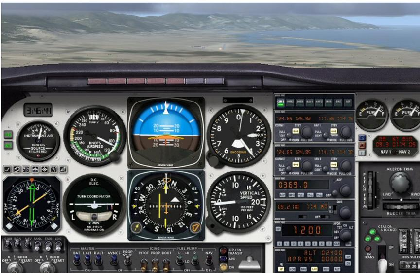
On est en train de passer la verticale du point FAF, on voit le basculement de la flèche jaune de l'ADF 369 du NDB BP.
