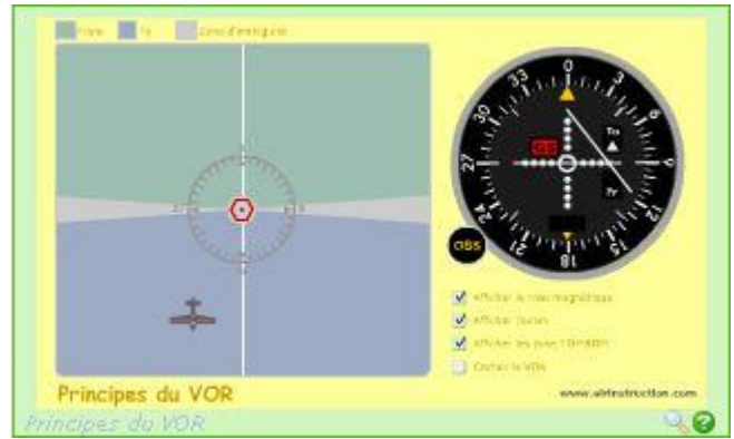
On est dans la zone TO et on s'éloigne du VOR
