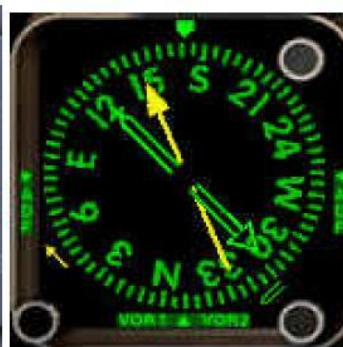
Trois instruments ADF différents, combinant l'aiguille de l'ADF (jaune) et celle du VOR 2 (verte).
