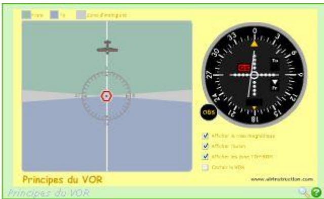
On est dans la zone FROM et on se rapproche du VOR
