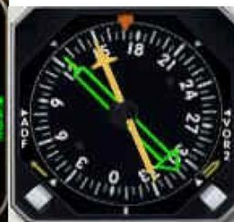
Trois instruments ADF différents, combinant l'aiguille de l'ADF (jaune) et celle du VOR 2 (verte).
