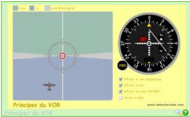
On est dans la zone TO et on se rapproche du VOR
