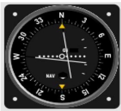
L'avion est trop haut et trop à gauche.
