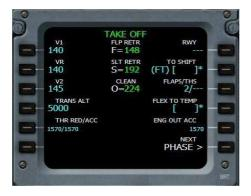
THR RED/ACC: il s'agit de l'altitude à partir de laquelle il faut réduire ou accélérer la poussée des réacteurs (THR Thrust).
