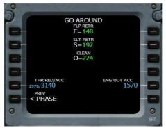
L'arrivée Go Around. A 224 kt, configuration lisse. A 192 kt, on met 1 cran de volet. A 148 kt, on est Full, toute la ferraille est dehors.
