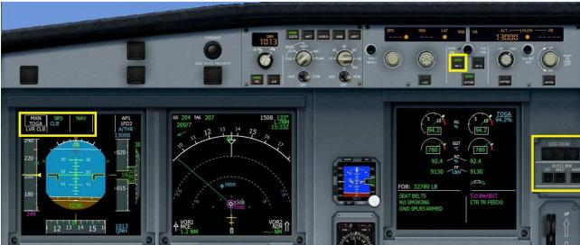
On vient de décoller. Vario positif, on a rentré le train. Pilote automatique enclenché (AP1). Attention, maintenant dès que LVR CLB clignote dans le FMA (Flight Management Annunciator entouré d'un cadre jaune à gauche), il faut diminuer la poussée des réacteurs (donc baisser les manettes de gaz) pour passer en LVR CLB (Climb). L'Auto Break s'est désenclenché automatiquement.
