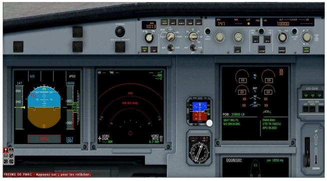
Maintenant que l'avionique est alimentée en électricité par l'APU, vous pouvez voir les différents écrans allumés sur le tableau de bord.
