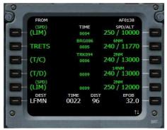
Voilà, le plan fait maintenant apparaître toutes les phases du vol avec la limitation de vitesse à 250 kt en-dessous des 10000 ft, le Top of Climb (T/C), le Top of Descent (T/D), à nouveau la limitation de vitesse...
