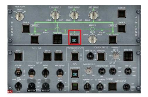
Vous pouvez maintenant enclencher l'APU BLEED qui est le générateur d'air pulsé nécessaire pour lancer les réacteurs.
