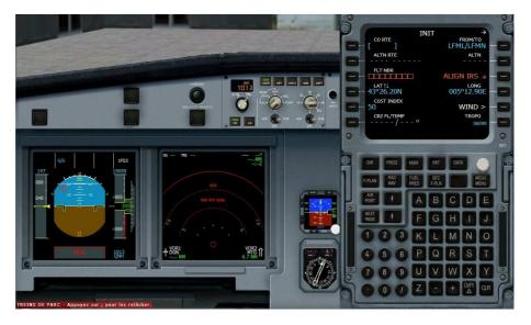
Sur l'écran du MCDU apparaît alors une nouvelle ligne en orange dans la case 3R : ALIGN IRS.
