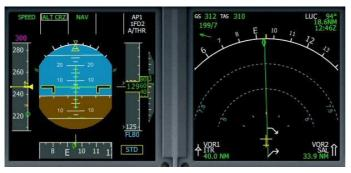
OK, on est en THR CLB (Thrust Climb, commande de poussée pour la montée).
