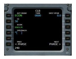
CLB: la phase de montée (climb)... On décide de la faire à une vitesse de 240 kt. On saisit 240 au clavier numérique et on clique sur 4L pour la valider. On passe à la suite en cliquant sur 6R PHASE.
