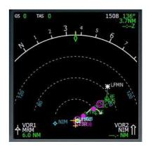
Sur le Navigation Display on peut voir le plan en entier. En jouant sur les boutons du mode de représentation et sur celui du range, vous pourrez détailler toutes les phases de ce plan.
