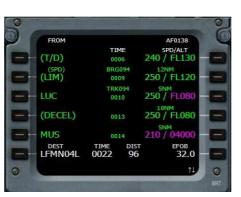
OK pour MUS. On descend dans le plan de vol avec la flèche verticale montante.
