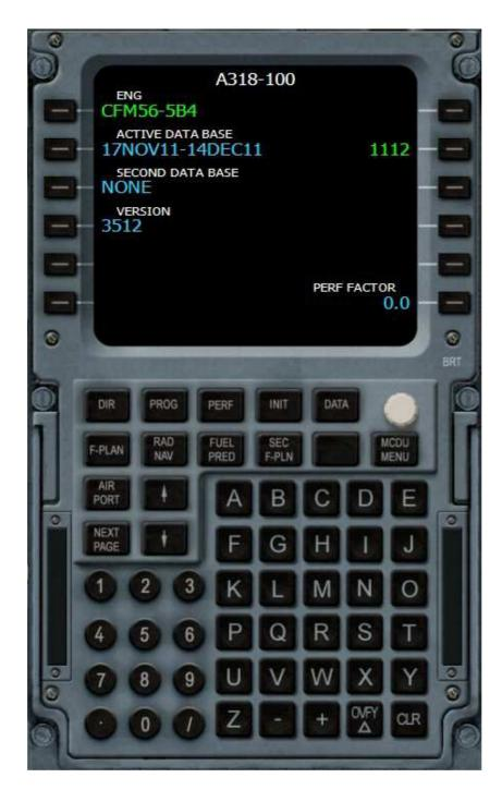
Le MCDU (Multifunction Control and Display Unit) constitue l'interface entre le pilote et le FMGC (Flight Management and Guidance Control) ou ordinateur de management de vol.
