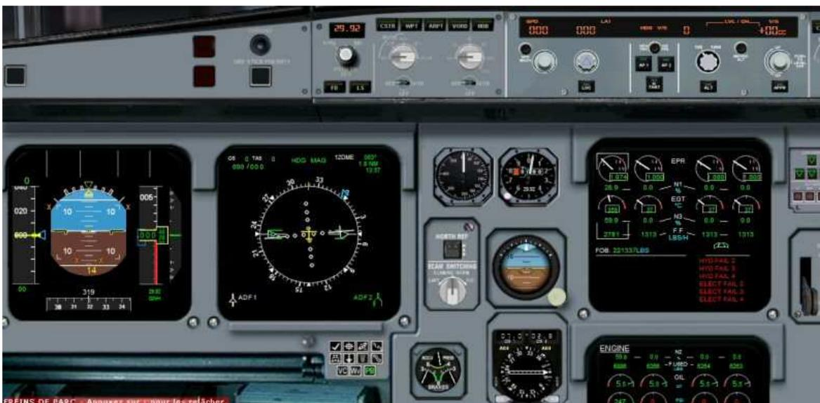
L'Engine Warning Display EWD affiche toujours des messages en rouge... Normal, les moteurs 2, 3 et 4 sont à l'arrêt donc l'EWD signale HYD FAIL 2, 3, 4 et ELECTRIC FAIL 2, 3 et 4. Dès la mise en route de ces moteurs, ces messages disparaîtront.
