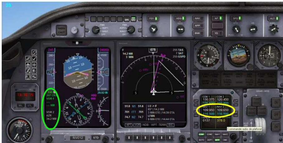
Les fréquences sont mises, 109.95 en NAV1 et 109.65 en NAV2.
